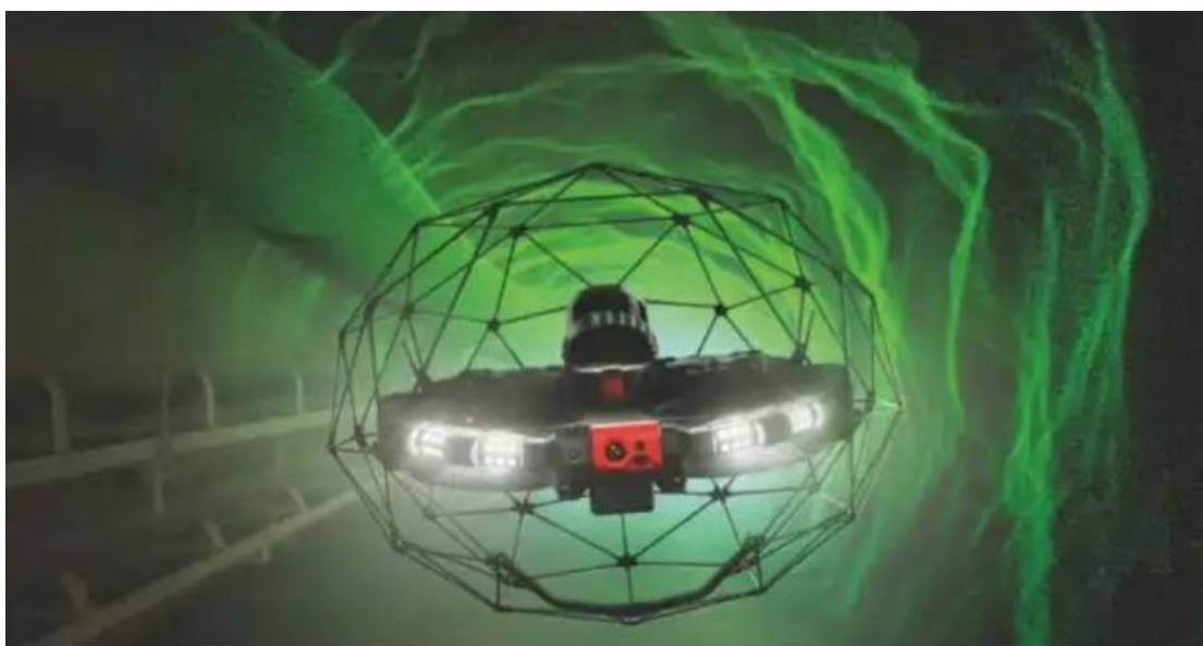
图 1 密闭空间无人机测量实物图
